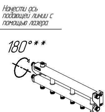
\*\* Для верхней подводки потребителей допускается перевернуть коллектор на 180° по горизонтальной оси
