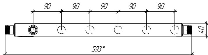
\* Используется для разметки отверстий кронштейнов
